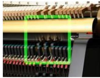
新センサー「インテグレートッド・ハンマーセンシング・システム」を採用。より正確な鍵盤タッチを実現しています。
