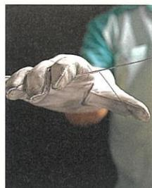
低音部の弦への銅線の巻きつけは、非常にデリケートな技が求められます。この作業では、熟練の職人が巻線を一本一本ていねいに手巻きすることで、最高の品質を生み出しています。
